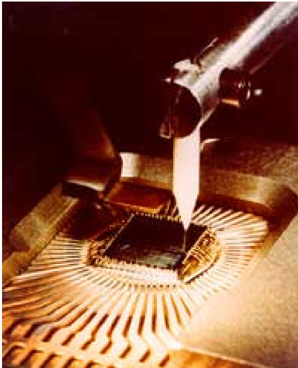
Bondkopf mit Chip auf Substrat
